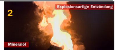
Mineralöl bildet Dämpfe welche zu einer explosiven Entzündung führen.
