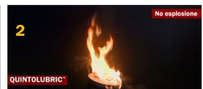
QUINTOLUBRIC® 888-46 produce una accensione controllata, nessuna esplosione e controllo della situazione finale.
