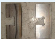
Excesivo/prematuro desgaste de paletas.
