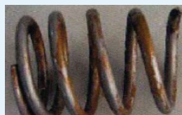
Ejemplo de varias áreas de oxidación detectadas.
