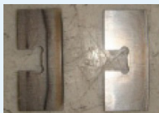
Excesivo/prematuro desgaste de paletas.
