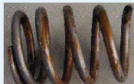
Ejemplo de varias áreas de oxidación detectadas.
